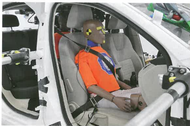
V obou větvích bezpečnostního pásu jsou instalovány měřiče síly v pasu
