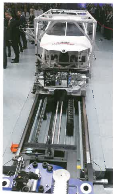
Nedestruktivní zkouška využívá obrovské zrychlení směrem vzad, které simuluje opačný náraz ve směru vpřed
