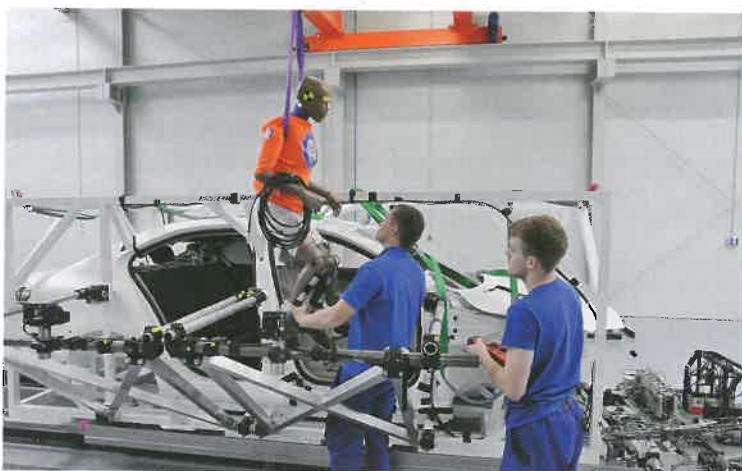
V obou větvích bezpečnostního pásu jsou instalovány měřiče síly v pasu
