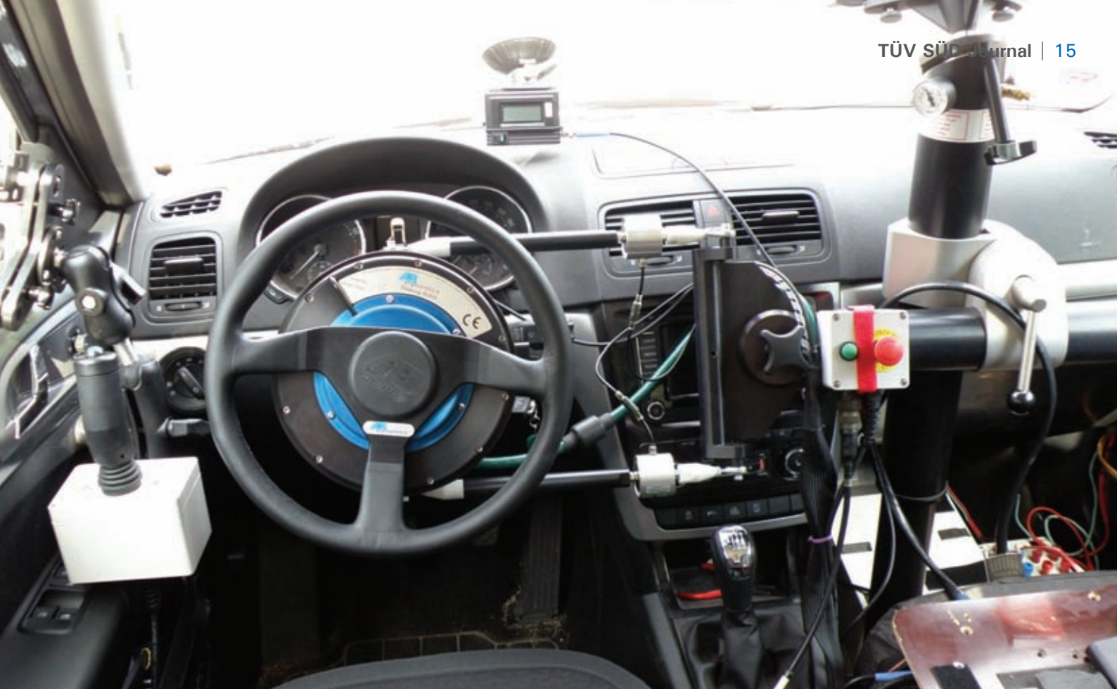
Jednou částí robota je volant se servomotorem
