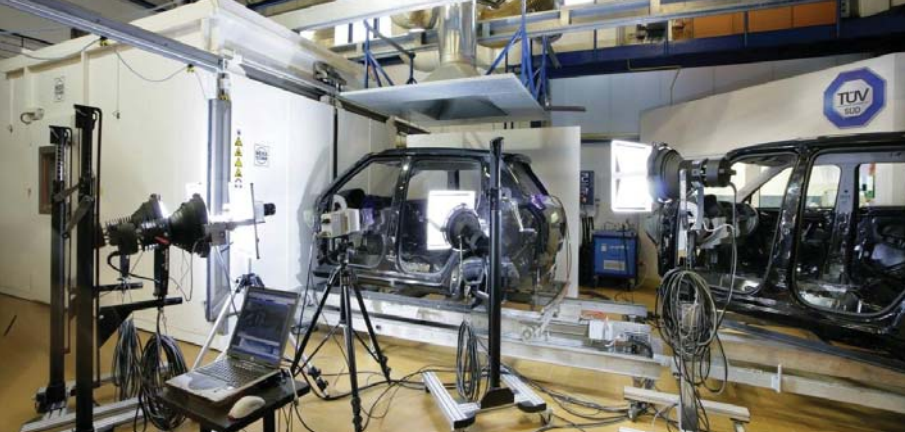
Pomocí saňových zkoušek lze bezpečnostní komponenty testovat nedestruktivně, dynamické crash testy nastavují reálné situace nehod za laboratorních podmínek (viz níže).
